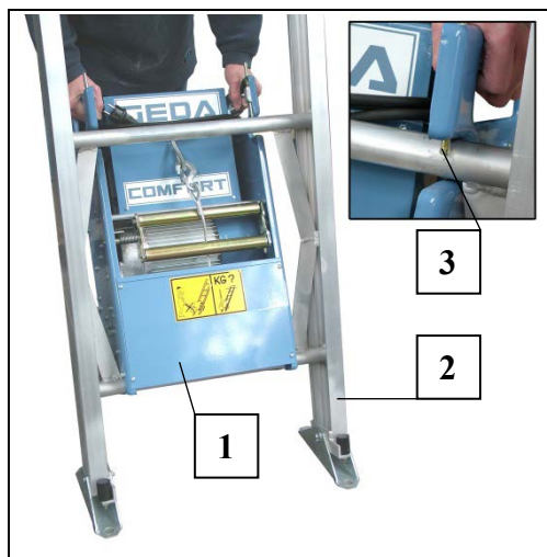
Fig. 31 Utilizarea troliului de cablu
